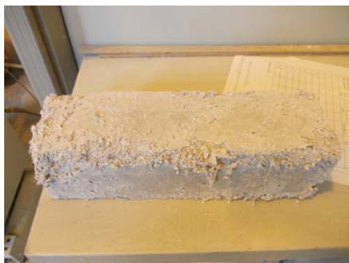
17. ábra. 10 fagyási cikluson átesett próbatest
