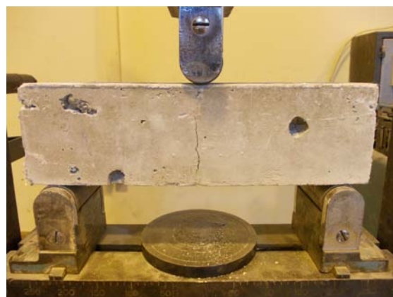
16. ábra. Pórusbeton adalékanyagos keverék tönkremenetele
