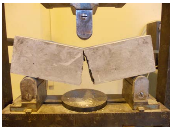
15. ábra. Kvarckavics adalékanyagos keverék tönkremenetele
