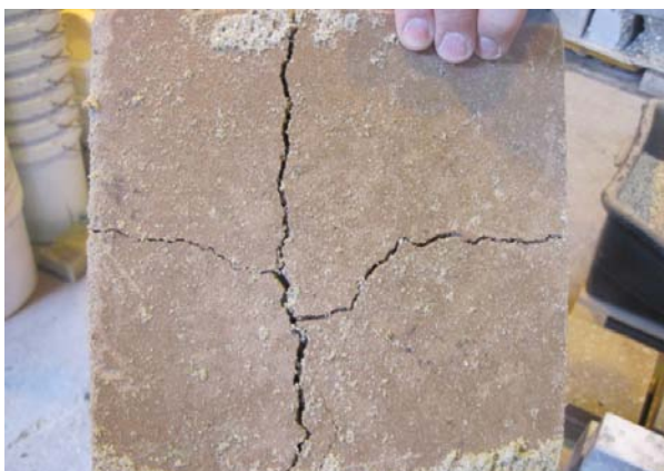
20. ábra. Ütésállósági vizsgálat során tönkrement próbatest
