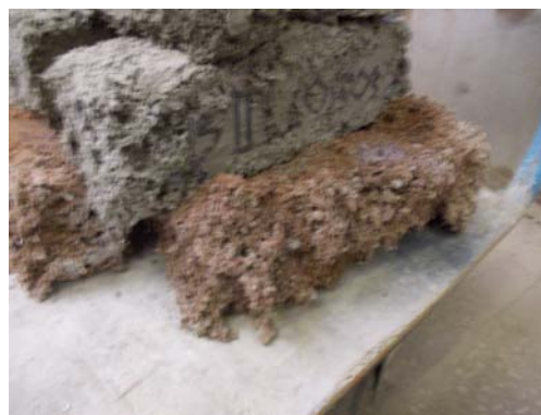
18. ábra. 25 fagyási cikluson átesett próbatest
