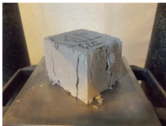
14. ábra. Tönkrement nyomószilárdsági próbatest
