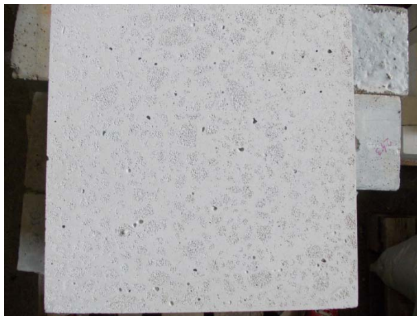
6. ábra. Hővezetési vizsgálat próbateste
