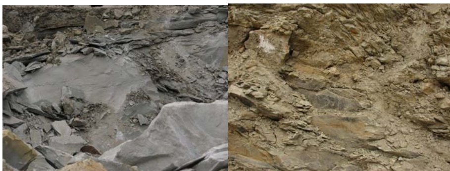
9. ábra. A márga üde szürke (bal oldali kép) és mállott, oxidálódott sárga (jobb) változata
