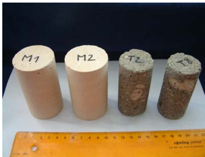
1. ábra: Durva mészkőből és riolittufából kialakított próbatestek ( coarse limestone and rhyolite tuff cylindrical samples )
