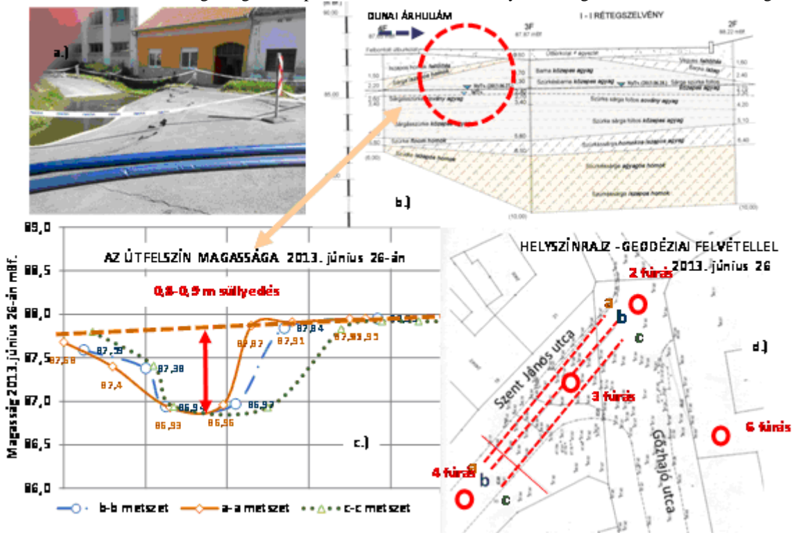
2. ábra. A kialakult károsodás fényképe, helyszínrajzi helyzete, metszete és a talaj rétegszelvénye. (The resulting damage photography of the road surface, layout position, cross section with the soil layers.)
