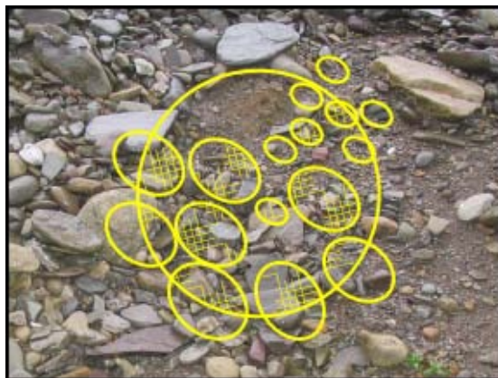
2. ábra. Talajmátrixba ágyazott tömbök (Boulder-Soil Matrix Mixed Face Ground) (Toth et al. 2013)
