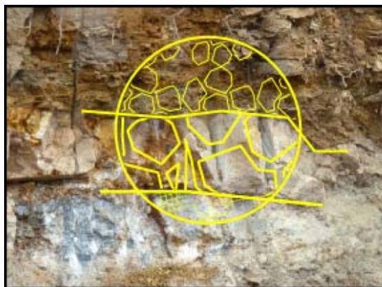
1. ábra. Talajjal és puhább kőzettel fedett alapkőzet (Rock-Soil Interface Mixed Face Ground) (Toth et al. 2013)
