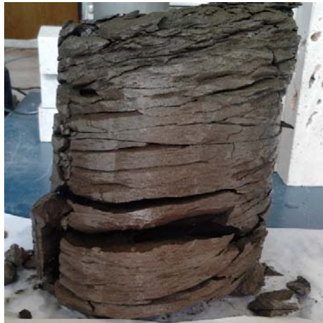
3. ábra. Telítés során szétesett próbatest ( Failure of the specimen caused by water saturation )
