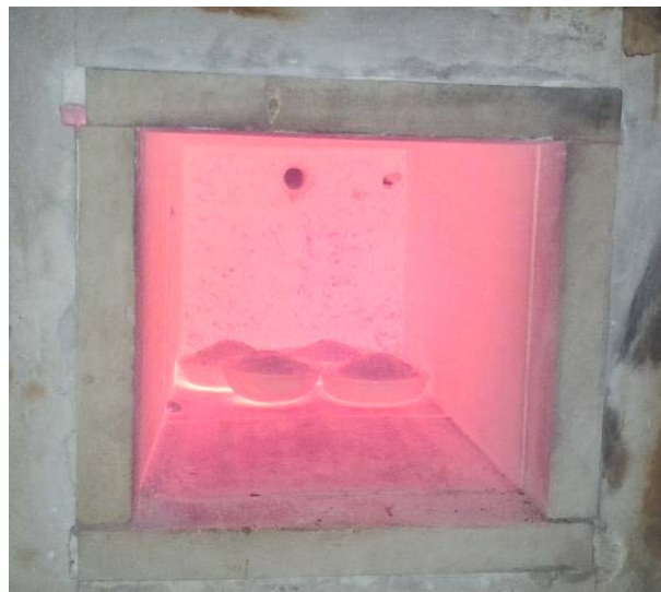
30. ábra. Márga kiégetése kemencében
