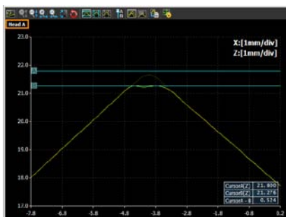
6. ábra Kitöredezési mélység „Z” irányú mérése ( Measuring of „Z” depth of the edge chipping )
