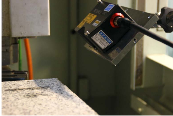
2. ábra A profilszkennert elhelyezése a megmunkáló központon ( The position of the profil-scanner on the machining centre )
