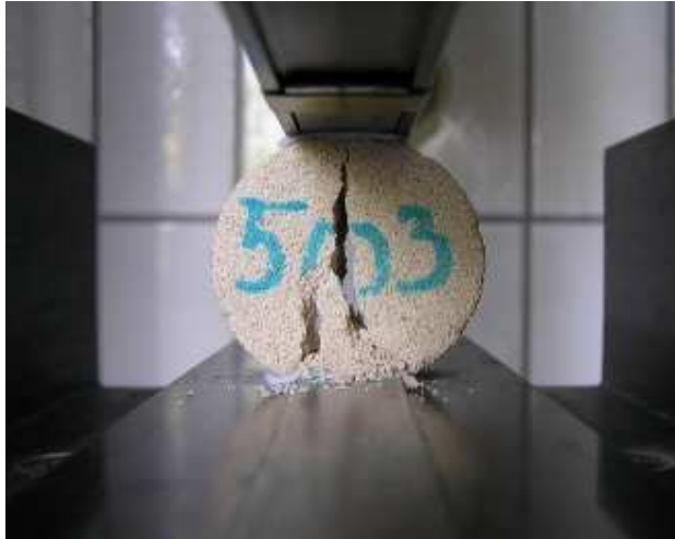
1. ábra. Mészke minta tönkremenetele brazil vizsgálatkor
