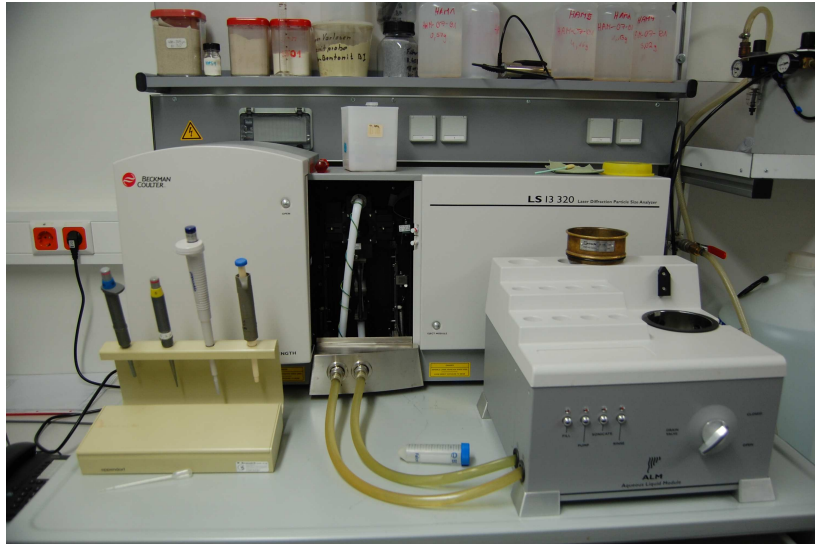
2. ábra. Részecskeméret analízishez használt lézerdiffrakciós készülék
