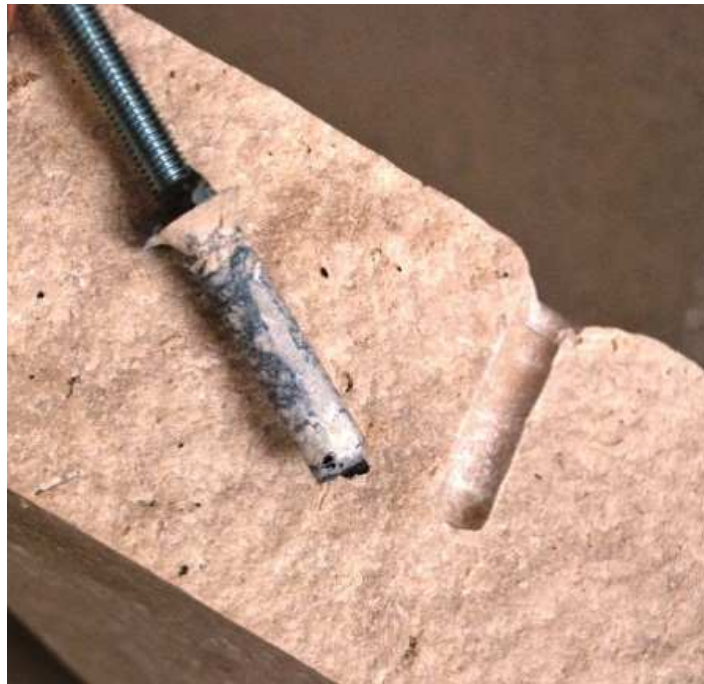
10. ábra. Tapadás megszűnése, rögzítőelem kihúzóda édesvízi mészkő próbatestből
