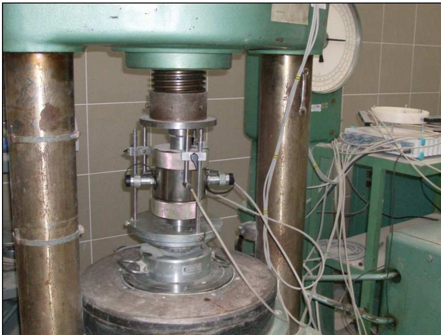
2. ábra. A BME Építőanyagok és Mérnökgeológia Tanszék triaxiális vizsgálóberendezése
