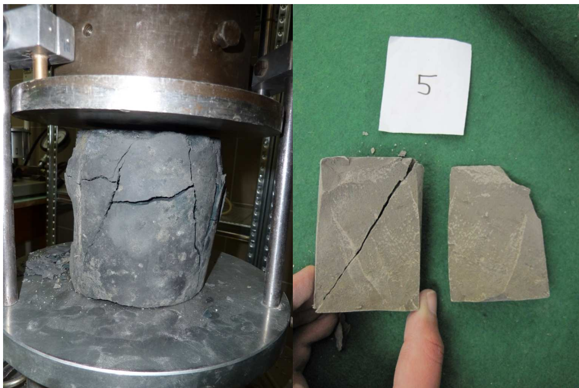
6. ábra. Pernye (bal oldal) és kiscelli agyag (jobb oldal) törésképe
