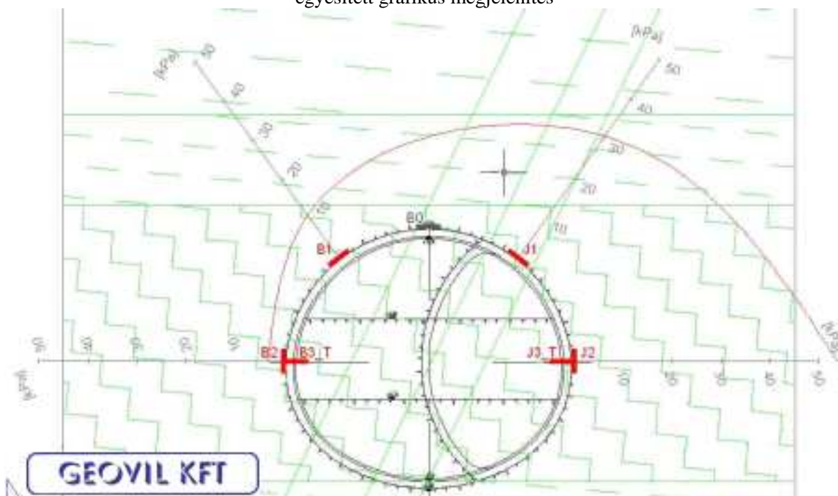
5. ábra. Közetnyomás mérések – 75,5 m alagútszelvénybe telepített műszerek és 2010. januárban mért közetnyomás eloszlás [kPa]
