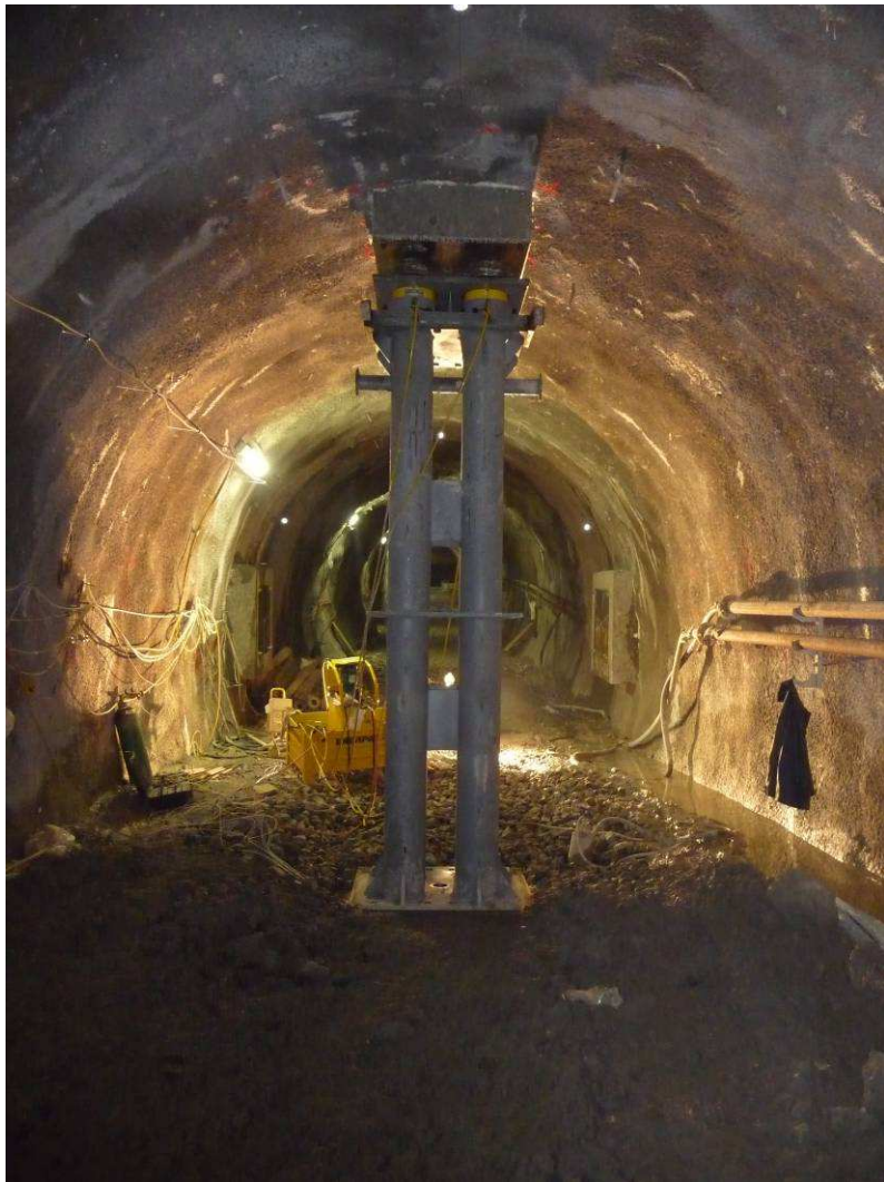
3. ábra. A fészítő szerkezet függőleges vizsgálat közben
