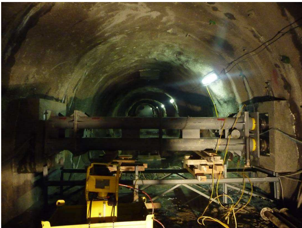
4. ábra. A fészítő szerkezet vízszintes vizsgálat közben
