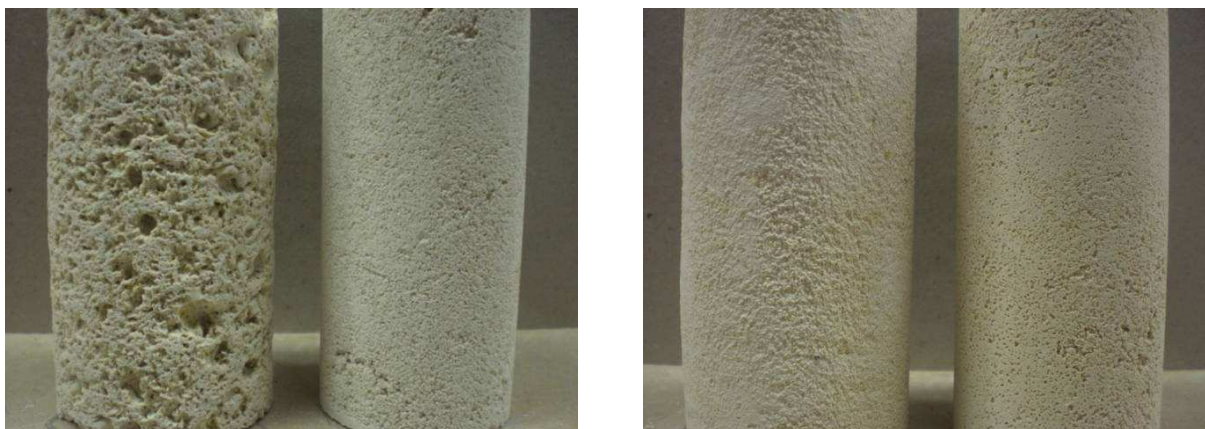
1.ábra Eltérő szövétű sóskúti durvamészke próbatestek (képek bal oldalán) és kőkiegészítő habarcsok (képek jobb oldalán) különböző szövetszerkezete. A jobb oldali kép páron a mészke és a kőkiegészítő habarcs nagyobb hasonlóságot mutat.
