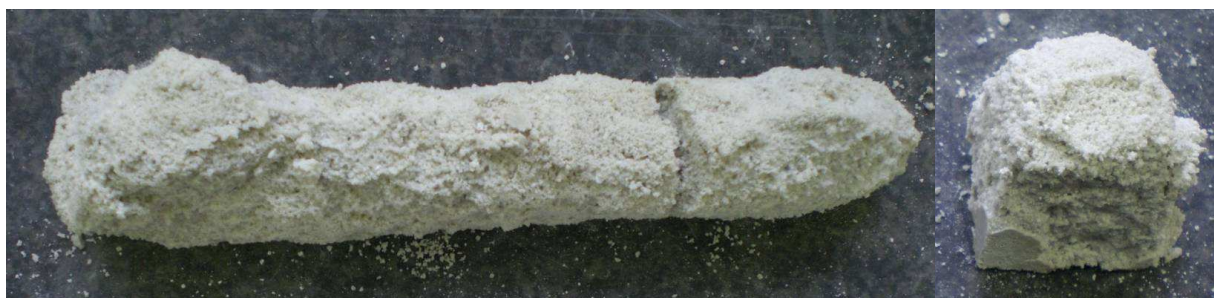
8. ábra. 100 fagyasztási cikluson átesett 4x4x16cm-es hasáb, illetve 3x3cm-es mintakocka. Ezek a próbatestek (7-8- ábra) a szabványos fagyasztóládában voltak tárolva, azaz állandóan telítve lettek vízzel, minden egyes fagyasztás előtt. Szomorúak lennének, ha az műemlékeinken használt kőkiegészítők 2-3 év (évi 25 fagy ciklussal számolva) alatt így „lemorzsolódnának”.
