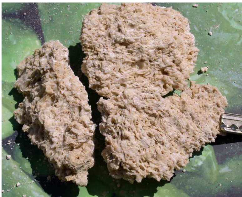
5. ábra. Durvaszemű, bioklasztos durva mészkő 1. emeleti falazatban
