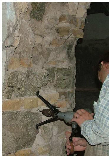
9. ábra. A falazóhabarcs szilárdságvizsgálata HF (habarcsfúró) készülékkel
