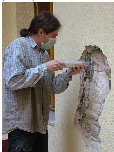
8. ábra. Helyszíni roncsolásmentes szilárdságvizsgálat Schmidt kalapáccsal
