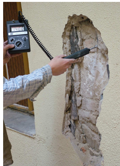
10. ábra. Helyszíni roncsolásmentes nedvességvizsgálat GANN Hydromette RTU 600 típusú nedvességmérő műszerrel
