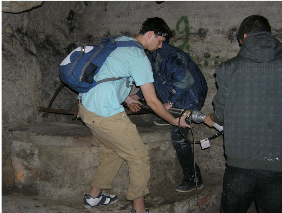
4. kép. A Német kút szivattyúzása a 100 l/perc teljesítményű szivattyúval
