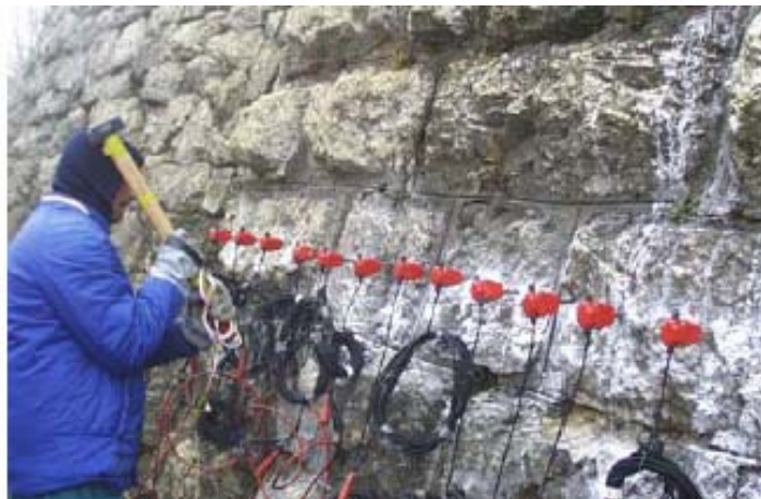
2. ábra. Híd lábzatának vizsgálata „kalapácsos szeizmikával”, beton és ágyzatának vizsgálata akusztikus szelvényezéssel
