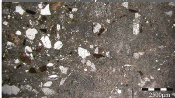
20. ábra: A noszvaji barlanglakás kőzet- mintájából készült vékonycsiszolat mikro- szkópi felvétele
