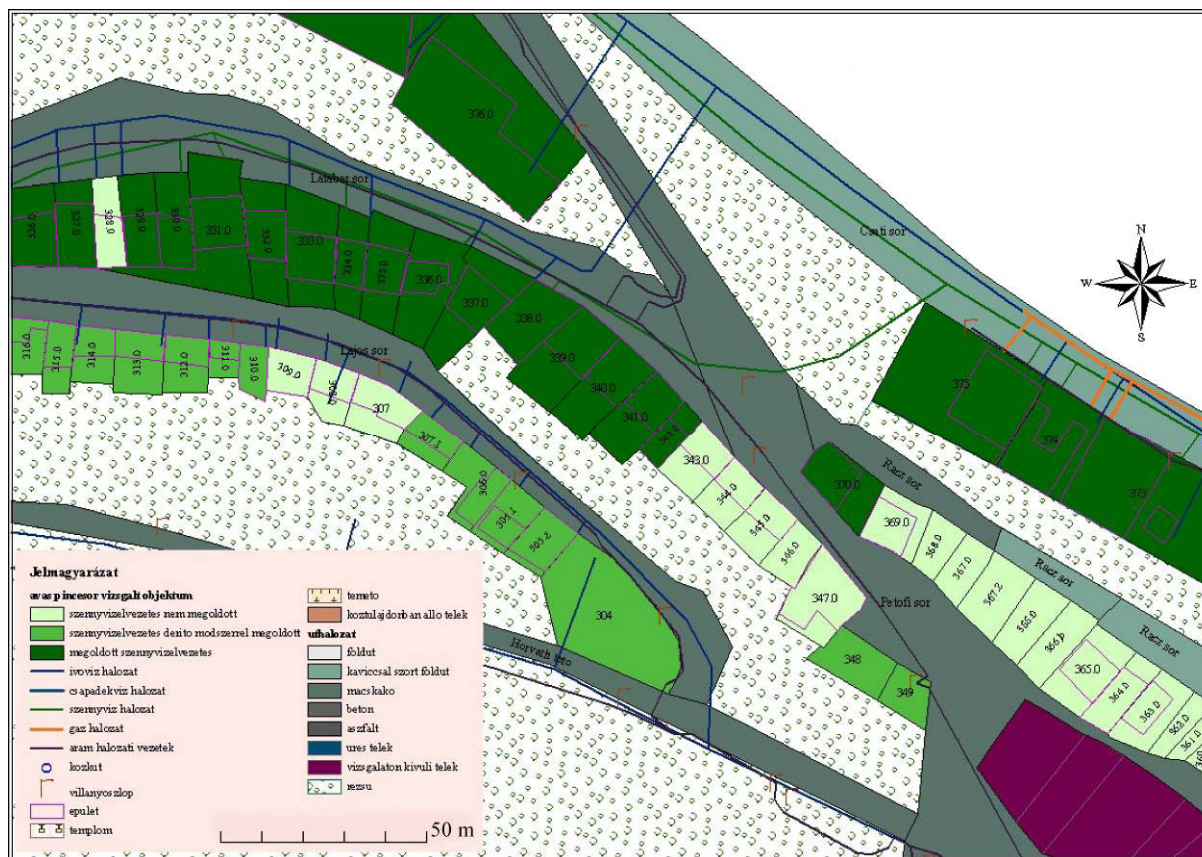
7. ábra: A nagyvasi pincesor telkeinek szennyvízelvezetési kiépítettsége
