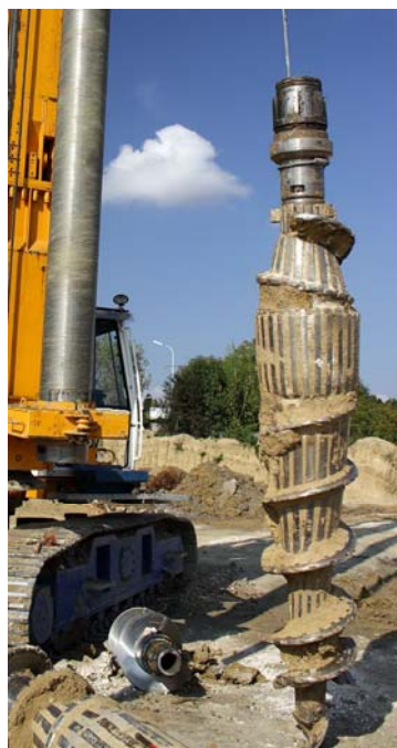
2. ábra. Az Omega cölöpözéshez használt fúrófej
