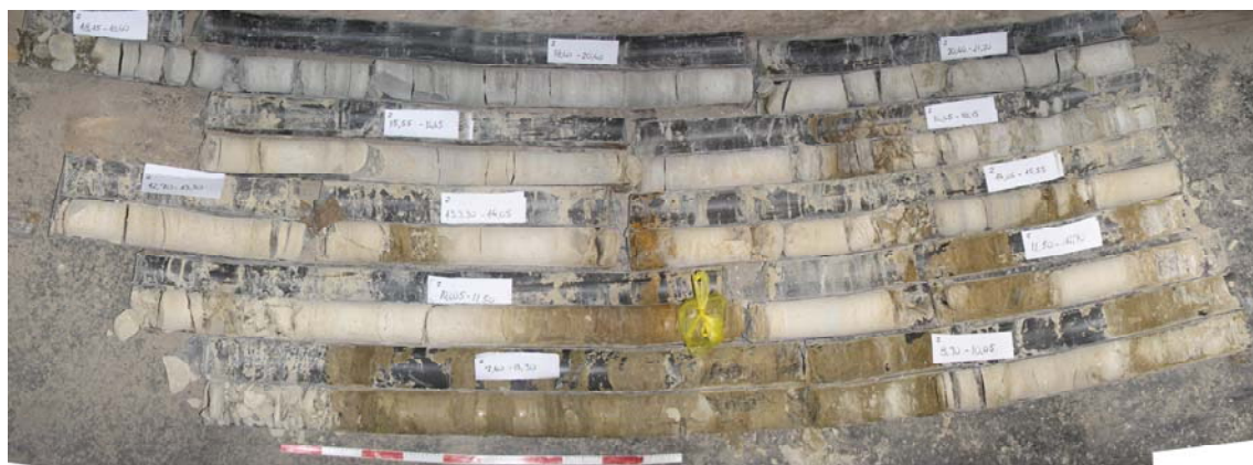
4. ábra. Mállott agyagmárga, sárga mállott mészmárga és szürke üde mészmárga a 2F jelű fúrás rétegsorában
