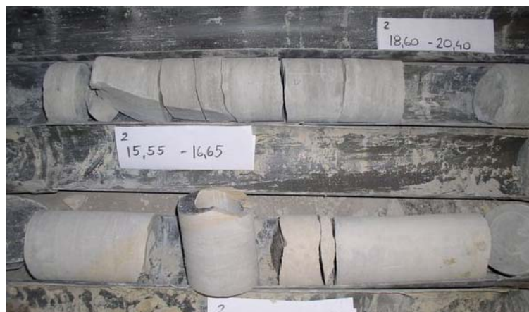
3. ábra. Sárgásszürke és szürke kemény, cementált mészmárga (2F)
