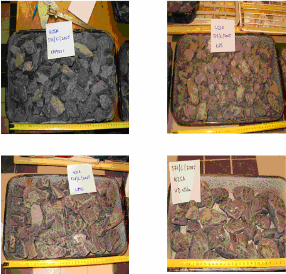
5. ábra. Bazalt (Uzsa) vasúti ágyazati zúzott kőanyag eredeti, Los Angeles-, vizes vasúti mikro-Deval- és vizes Deval vizsgálat utáni állapotban.
