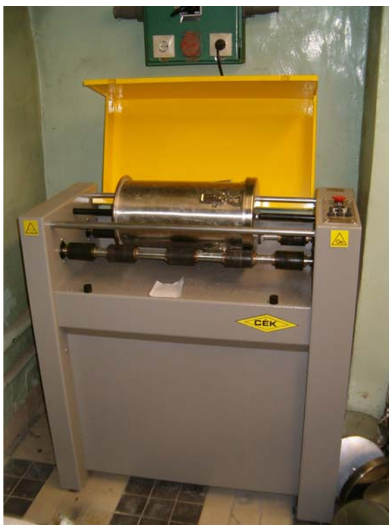
2. ábra. Mikro-Deval vizsgáló berendezés vasúti mikro-Deval dobbal.
