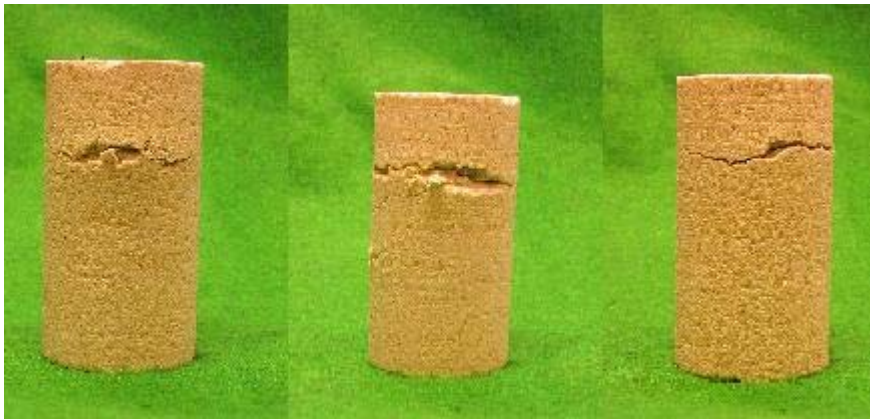
4. ábra. A finomszemű próbatetek átrepedése 5. fagyasztási ciklus után
