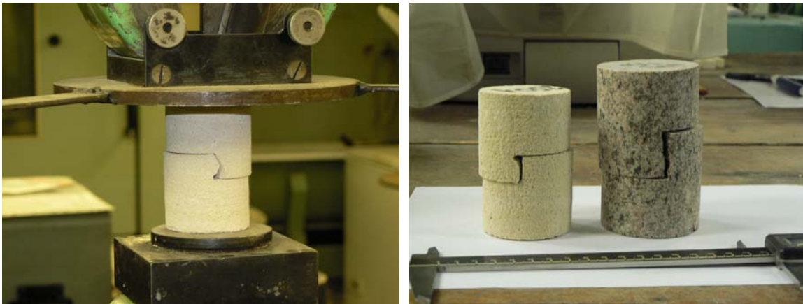
1. ábra. Bemetszett próbatest nyíróvizsgálata (bal oldalt) és vizsgálat utáni durva mészkő és gránit próbatestek (jobb oldalt)
