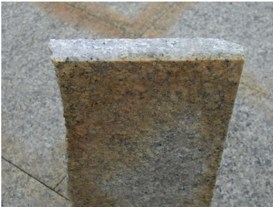
6. ábra. Az elszíneződött élű gránit lapon jól látszik, hogy a vasoxidos kiválás csak a lap felső élei mentén jelent meg. A kőzet szövetében elváltozás nincsen.
