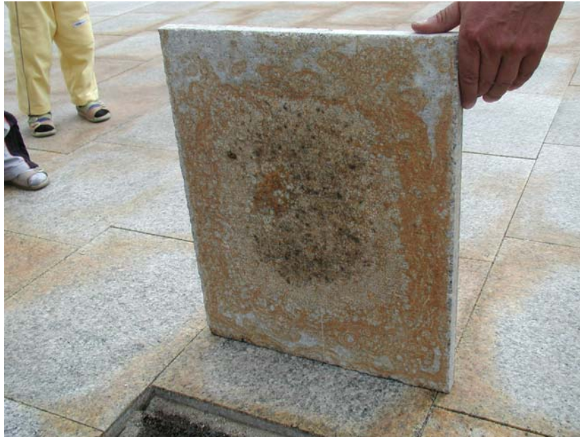
8. ábra. A kőlap hátsó oldalán a kioldódó vasoxidos elszíneződés megjelenése.
